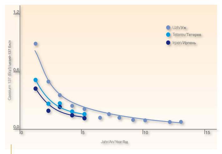
Vergleich von Messwerten und Modellrechnungen des TYPHOON-Modells für kleine Flüsse (Uzh, Irpen und Teterev) in der 30-km-Sperrzone. Es besteht eine gute Übereinstimmung zwischen der Rechnung für einen Zeitraum bis zu 13 Jahre und den beobachteten Messwerten aus der Überwachung.
