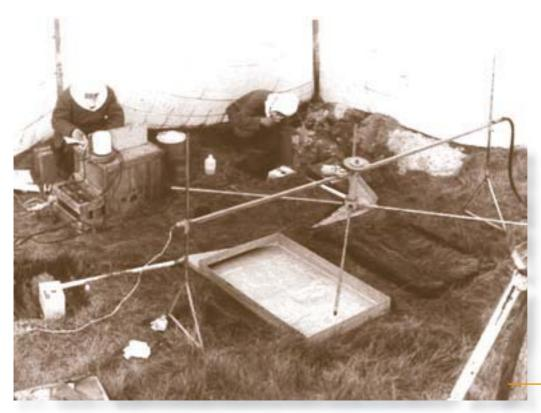
Mikro-Plot im Freien zur Bestimmung des oberflächigen Regenablaufes
